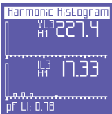
Histograma armónico de tensión y corriente de la fase L3.
