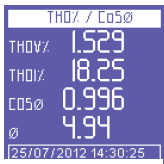
Valores de las THD% (Total Harmonics Distorsion - Tasa de distorsión armónica total) de tensión y corriente, valor del \text{Cos}\varphi y su ángulo expresado en grados (el signo negativo indica que la corriente anticipa la tensión y por tanto la carga es capacitiva).
